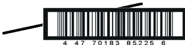
54 pav. Neteisingai krintantis spindulys ant brūkšninio kodo
