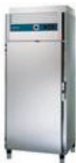
11 pav. Aušinimo spinta (nerūdijančio plieno vidus ir išorė, automatinis atitirpinimas ir vandens kondensato išgarinimas, oru aušinamas kompresorius viršutinėje kameros dalyje, 4 nerūdijančio plieno lentynos)
